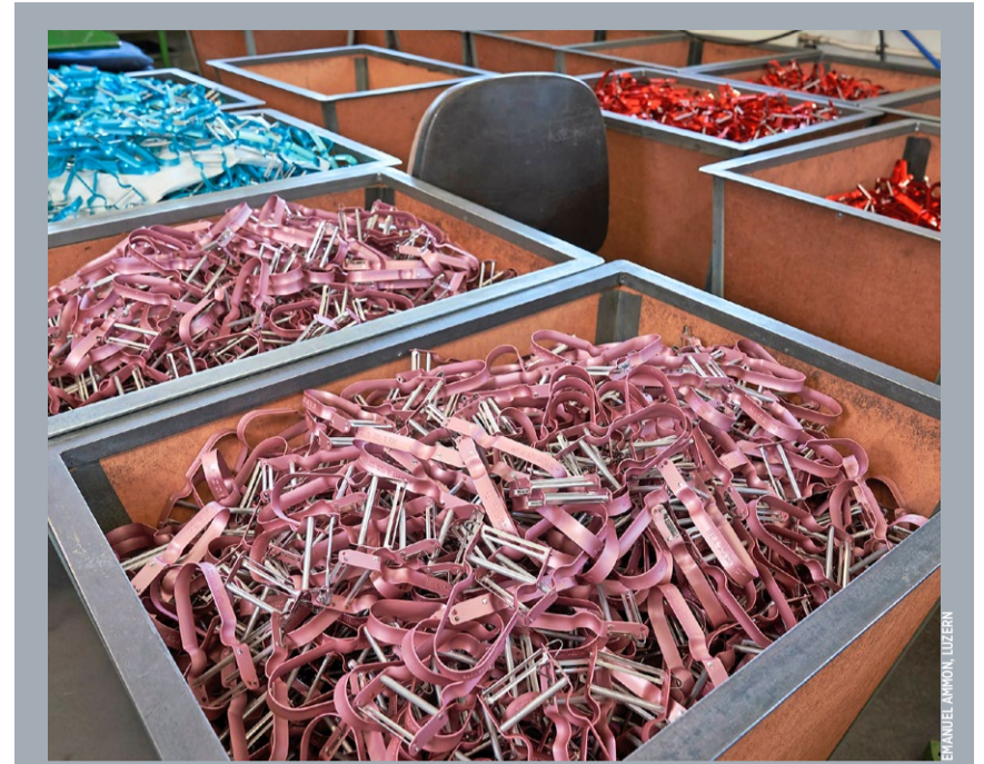
Farben: Beim Anodisieren kann jede Farbe gewählt werden. So wird der 13 Gramm schwere Rex auch zum Werbegeschenk.
